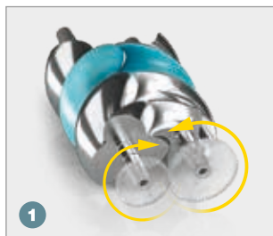
1 zamknięcie objętości zassanego powietrza
