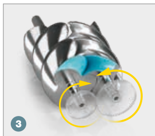
3 przesunięcie na stronę ciśnieniową
